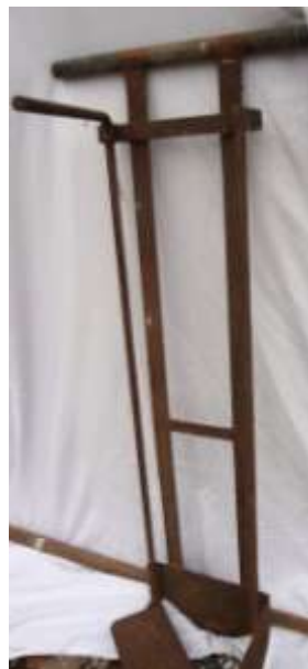
Nyere maskinspade med bevægelig vinge, funktionen var at skære tørv fri og være bundstøtte.
