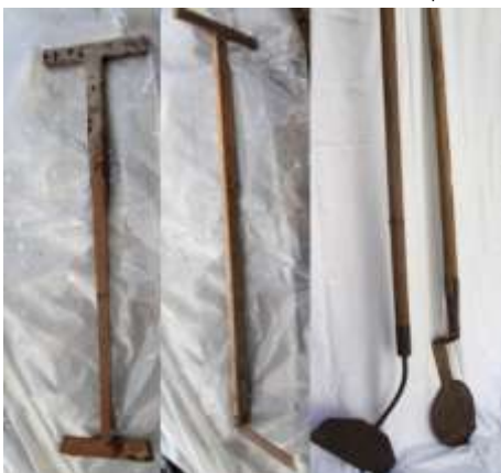
Nyere maskinspade med bevægelig vinge, funktionen var at skære tørv fri og være bundstøtte.
