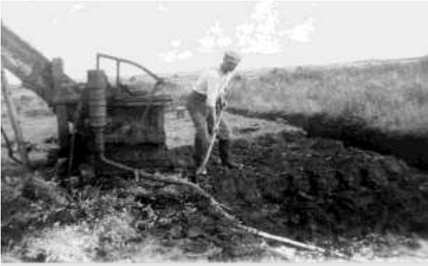
Pedersen, kaldet "Jens Støbr" graver tørvematerialet direkte op i æltemaskinen, der trækkes af en petroleumsmotor. Vandet pumpes op i æltemaskinen via en slange, Bendstrup Mose 1958.
