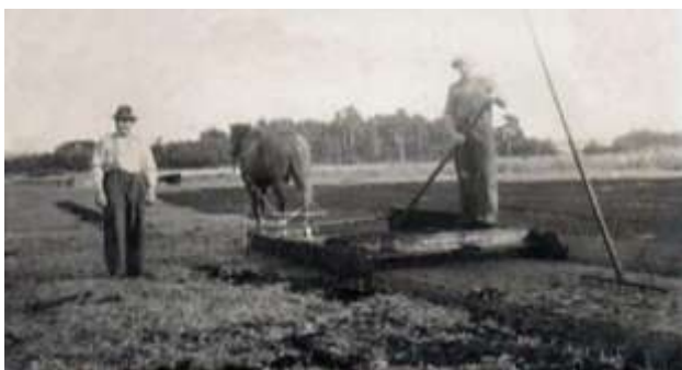
"Klipperen" kan minde om en slæde, der trækkes af en best, og som under fremkørslen hele tiden fyldes op med æltedynd fra "dyndvognen". Nogle metalskiner skærer dyndet op på langs. Den tværgående afskæring udføres manuelt med en stor rive – vist i forgrunden. Manden på "klipperen" udjævner dyndet under fremkørslenca. 1950.
